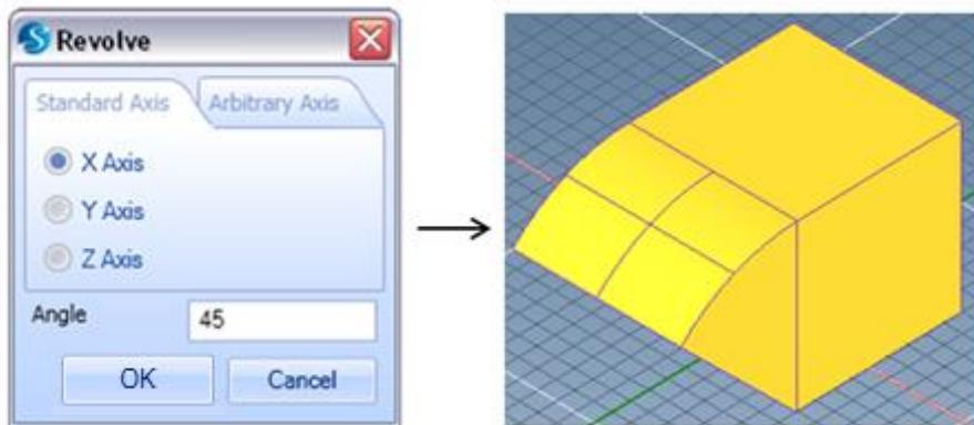
FIGURE 46- FACE REVOLVED BY A STANDARD AXIS
