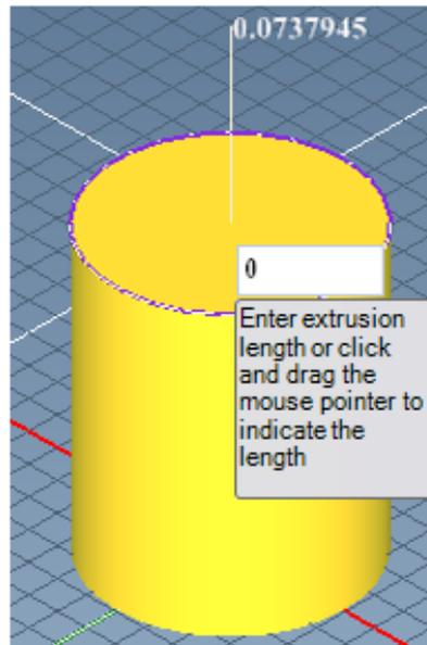
FIGURE 48- DRAG TO THE DESIRED EXTRUSION LENGTH
