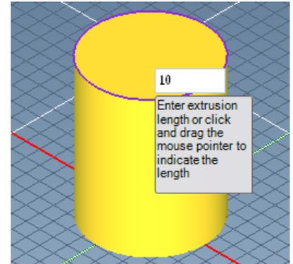
FIGURE 47- DEFINE THE EXTRUSION LENGTH
