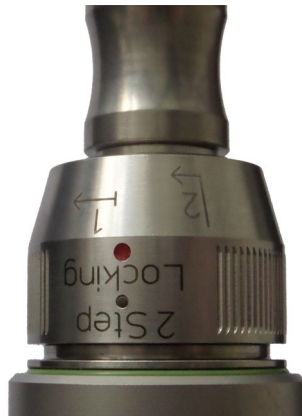
Abbildung 4.14.: Steckverbinder-Bauart der Faserkupplung: Optoskand QBH (hier mit eingesteckter Faser dargestellt)
