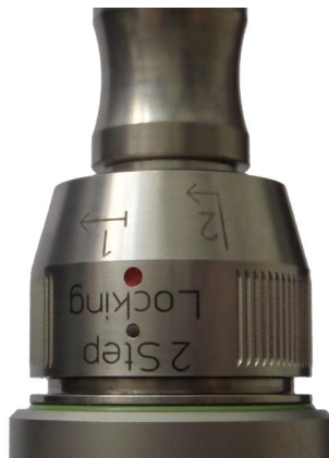
Abbildung 7.1.: Optoskand QBH Faserkupplung mit eingesteckter Faser
